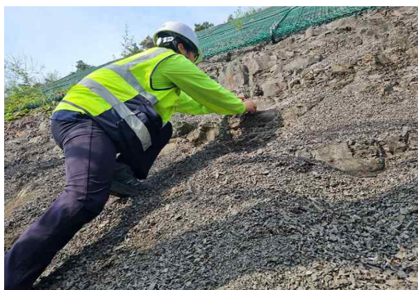
절리면 경사/경사방향 측정
